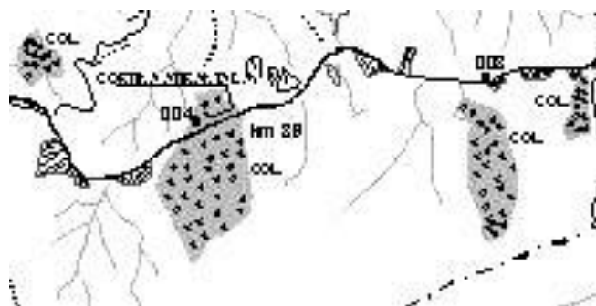
Figura 16: Interpretação de fotos aéreas indicando a existência de colúvios
